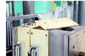
Werkzeugisolierung bei technischen Werkstoffen
